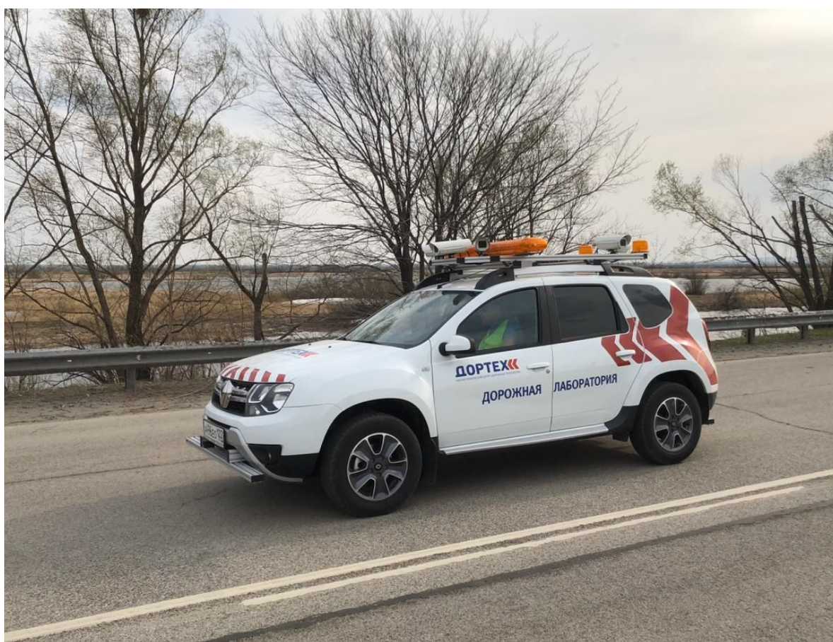
Рисунок 1.1 – Комплекс измерительный передвижной аэродромно-дорожной лаборатории КП-514 RDT Line
